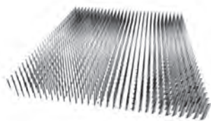
Obr. 8: Mapa systematických chyb stolku Physik Instrumente v celém objemu 200 \times 200 \times 20 mikrometrů, délka šipek je v rozsahu 0,1-1,3 \mu\text{m} . Při tomto měření nebyla využita kompenzace parazitních rotací.
